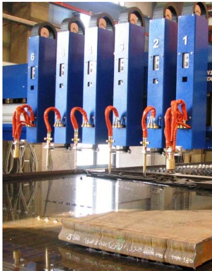
LKN 500 mit Spezialhitzeabdeckung LKN 500 with special heat shield
