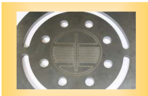
Schneidprobe mit Markierung (PerCut 370.1M)
